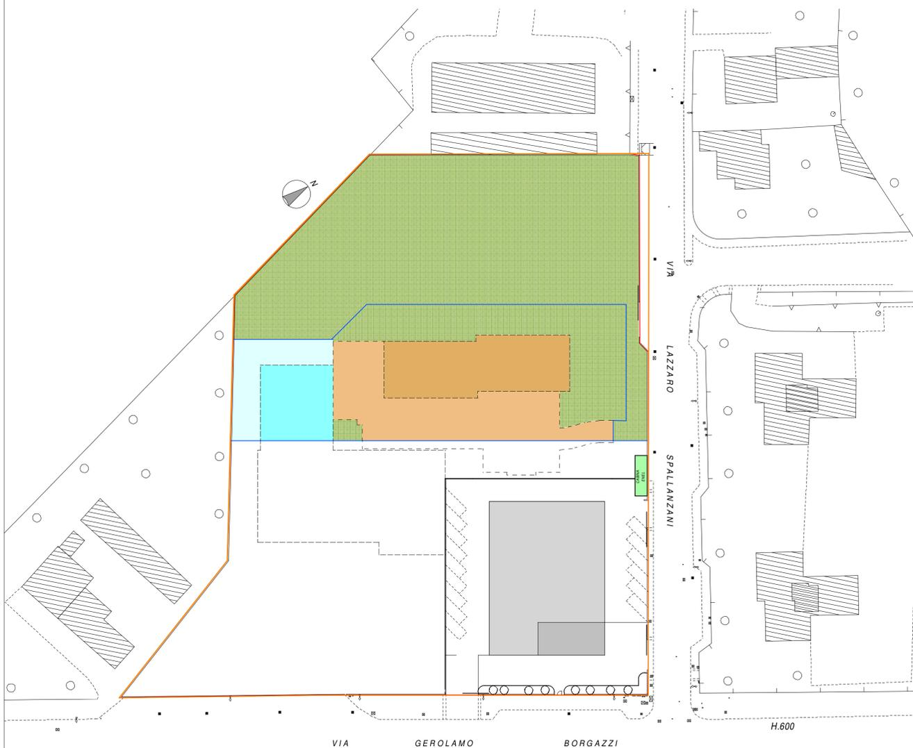
PLANIMETRIA GENERALE CON INDICAZIONE DELLE PORZIONI DI SUPERFICIE FONDIARIA RICADENTI NELL'AREA SOGGETTA A COMPENSAZIONE AMBIENTALE TRASFORMATE DA SUOLO "NON URBANIZZATO" A SUOLO "URBANIZZATO" - scala 1:500
