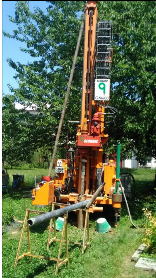
Foto 1 – postazione sondaggio geognostico per prova Lefranc
