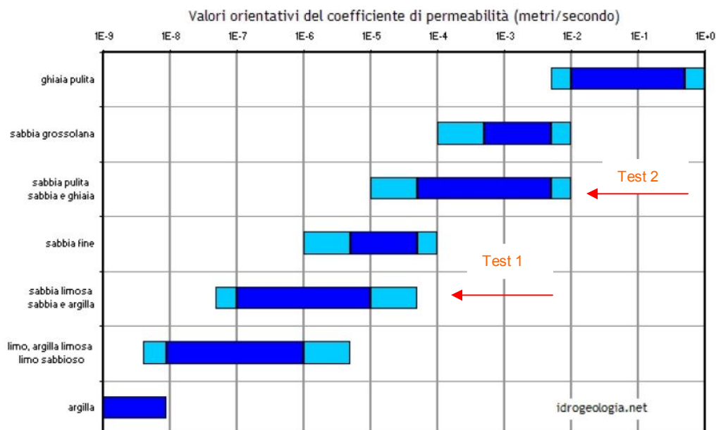
Figura 13 - valori della permeabilità orizzontale ( k_h ) per terreni a granulometria dalle ghiaie alle argille
