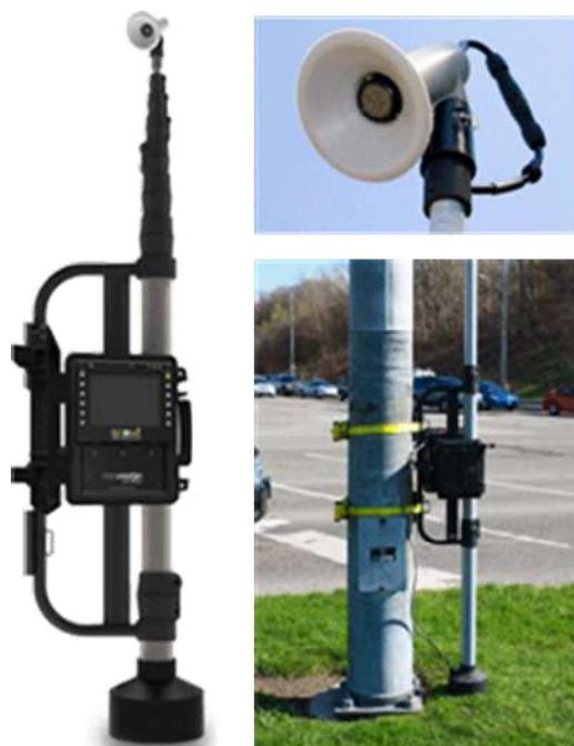
Figura 12 – Strumentazione video con palo telescopico
