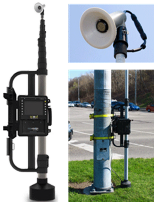
Figura 12 – Strumentazione video con palo telescopico
