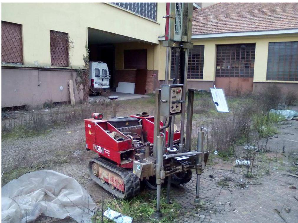
Esecuzione delle prove penetrometriche.
