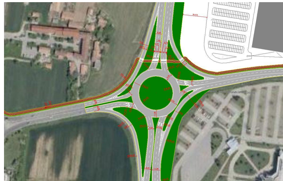
Figura 62 - Schema geometrico della nuova rotatoria
