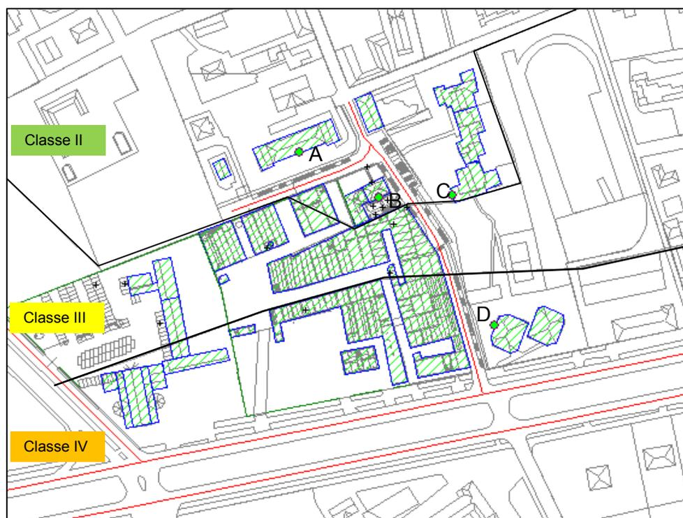
**Figura 20** - Vista planimetrica del modello di calcolo con individuazione dei recettori.
