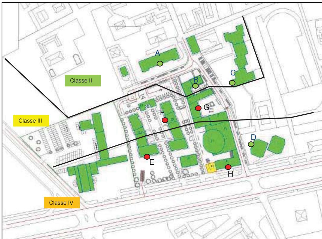
**Figura 30** - Vista planimetrica del modello di calcolo con individuazione dei recettori e delle classi acustiche: in verde i recettori già esistenti in rosso i recettori derivanti dal progetto.
