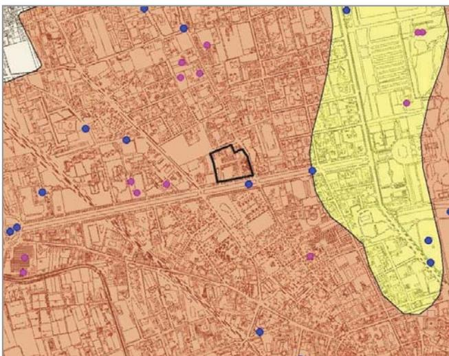
*Fig. 3.1 Vulnerabilità idrogeologica (secondo rea 2005). L'area è classificata come a "vulnerabilità elevata con possibilità di contaminazione del li acquifero" (massima per Monza). Come visto, in questa specifica area la vulnerabilità del II acquifero è molto improbabile.*
