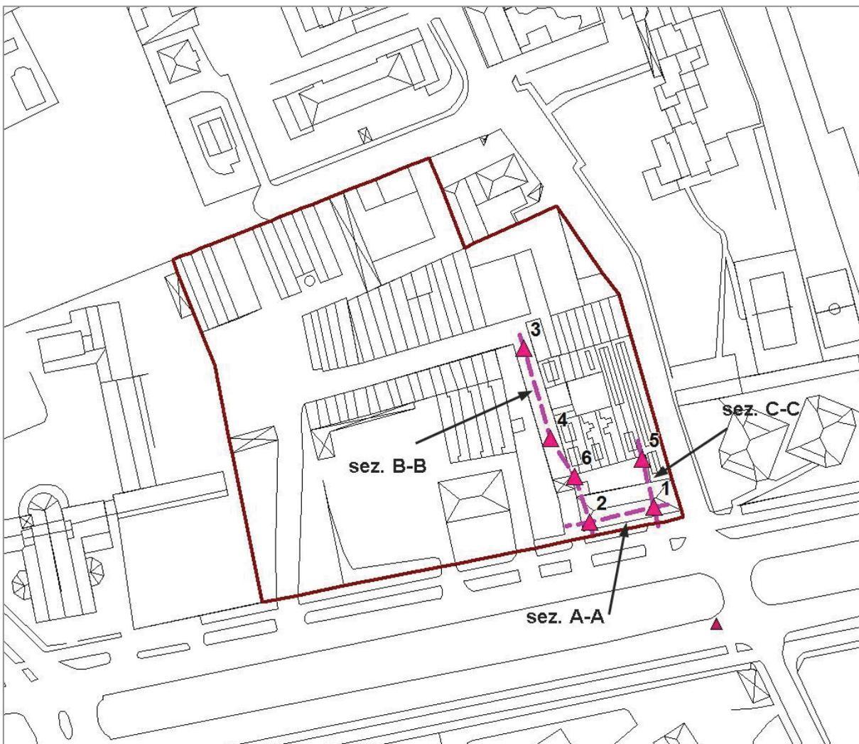
Fig. 2.9 Localizzazione delle prove penetrometriche del 1997 e traccia sezioni interpretative
