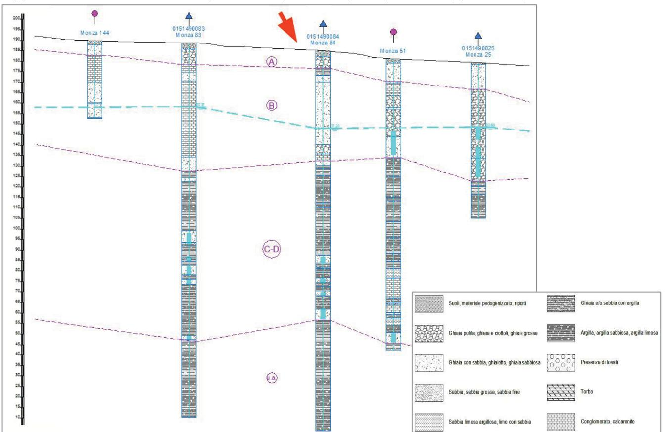
Le sezioni indicano la costante presenza di materiali grossolani nelle prime decine di metri di sottosuolo, ma con possibile presenza di pacchi conglomeratici, talvolta di notevole spessore e con scarsa continuità laterale, nonché di livelli di sabbie e ghiaie argillose. E' anche evidente la segnalazione di uno strato superficiale, in genere di 2-3 m, di materiali alterati e/o con componente organica e/o antropica.
